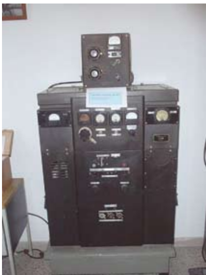
Il primo trasmettitore della stazione radio del CIRM un BC610 D della Hallicrafters
